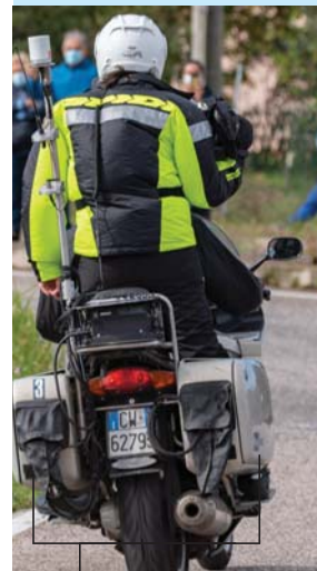
Bauletti con apparecchiature che consentono il collegamento con la regia
